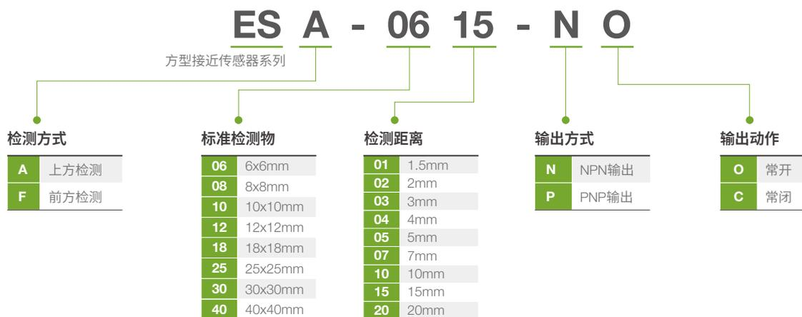
例：ESA-0601-NC 表示方型接近开关传感器，可检测物体为6x6x1mm，检测距离为1.5mm，NPN输出，常闭
